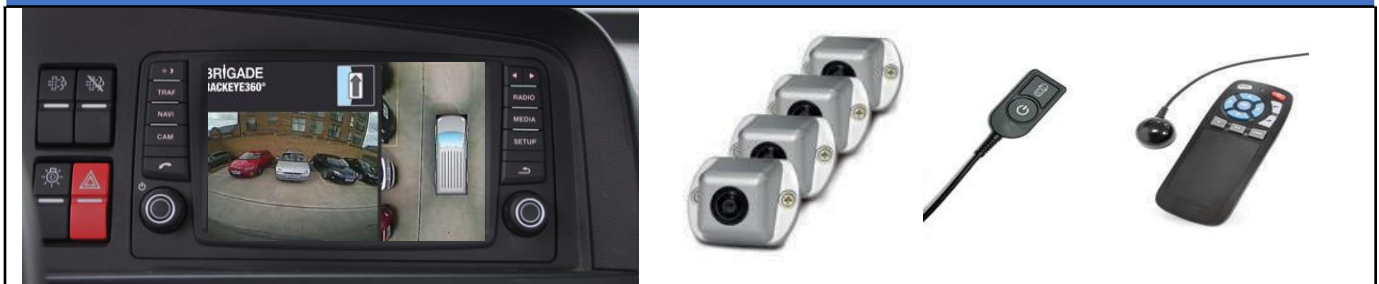
Backeye®360 System auf MMT2 MAN Infotainment
